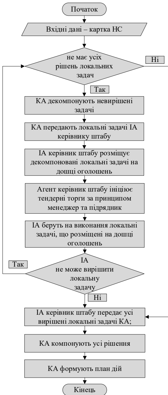
Рис. 2. Блок-схема загального алгоритму розрахунку плану дій агентами мультиагентної системи в умовах виникнення НС
